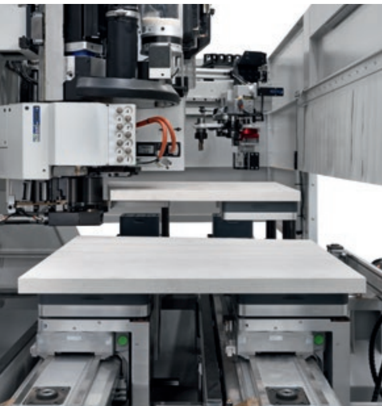
Пневматические системы фиксации Uniclamp и Hyperclamp с быстрым расцеплением для жесткой и точной фиксации.
